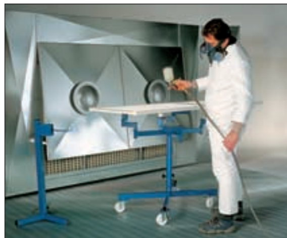
Только там, где возможно постоянное удаление лакового тумана и паров растворителя возможно образование качественных поверхностей.
